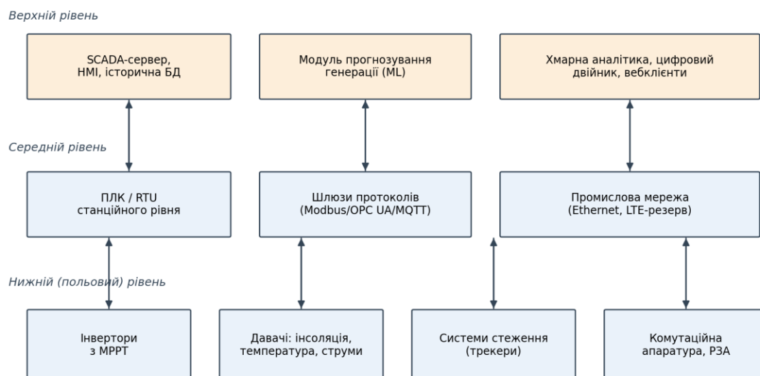
Рисунок 3.1 – Структурна схема автоматизованої системи керування СЕС
