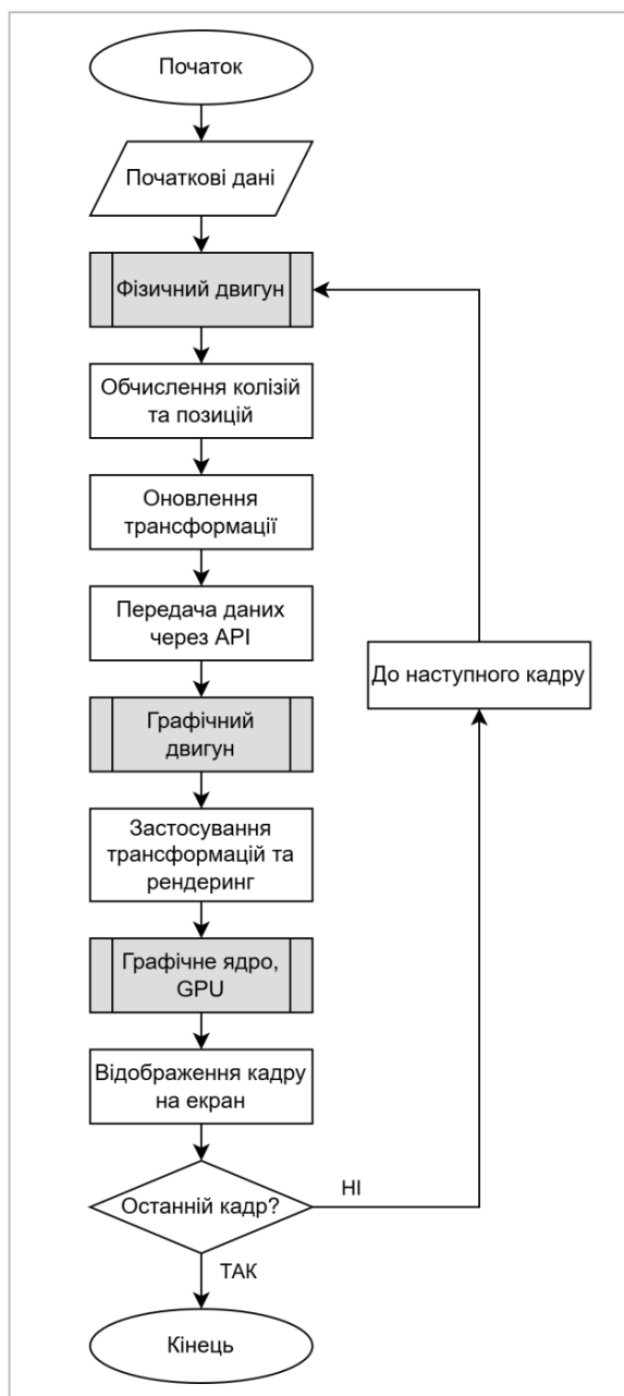
Рисунок 2.1 – Етапи взаємодії графічного ядра та фізичного рушія
