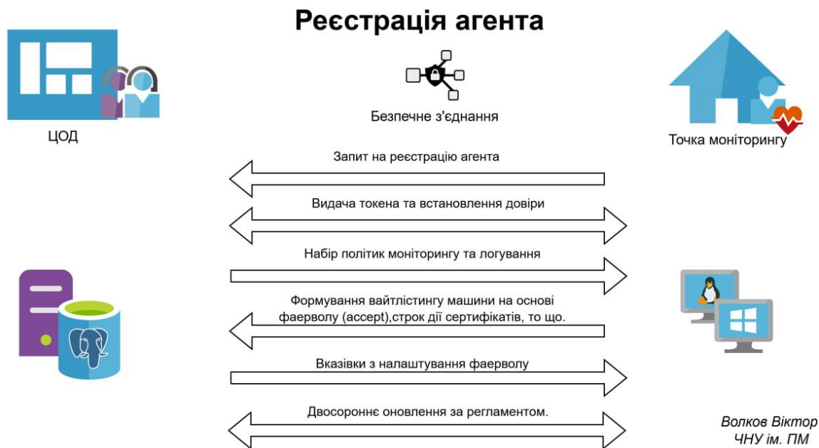
Рисунок 3.2 – Життєвий цикл агента моніторингу в системі Castle Monitor
