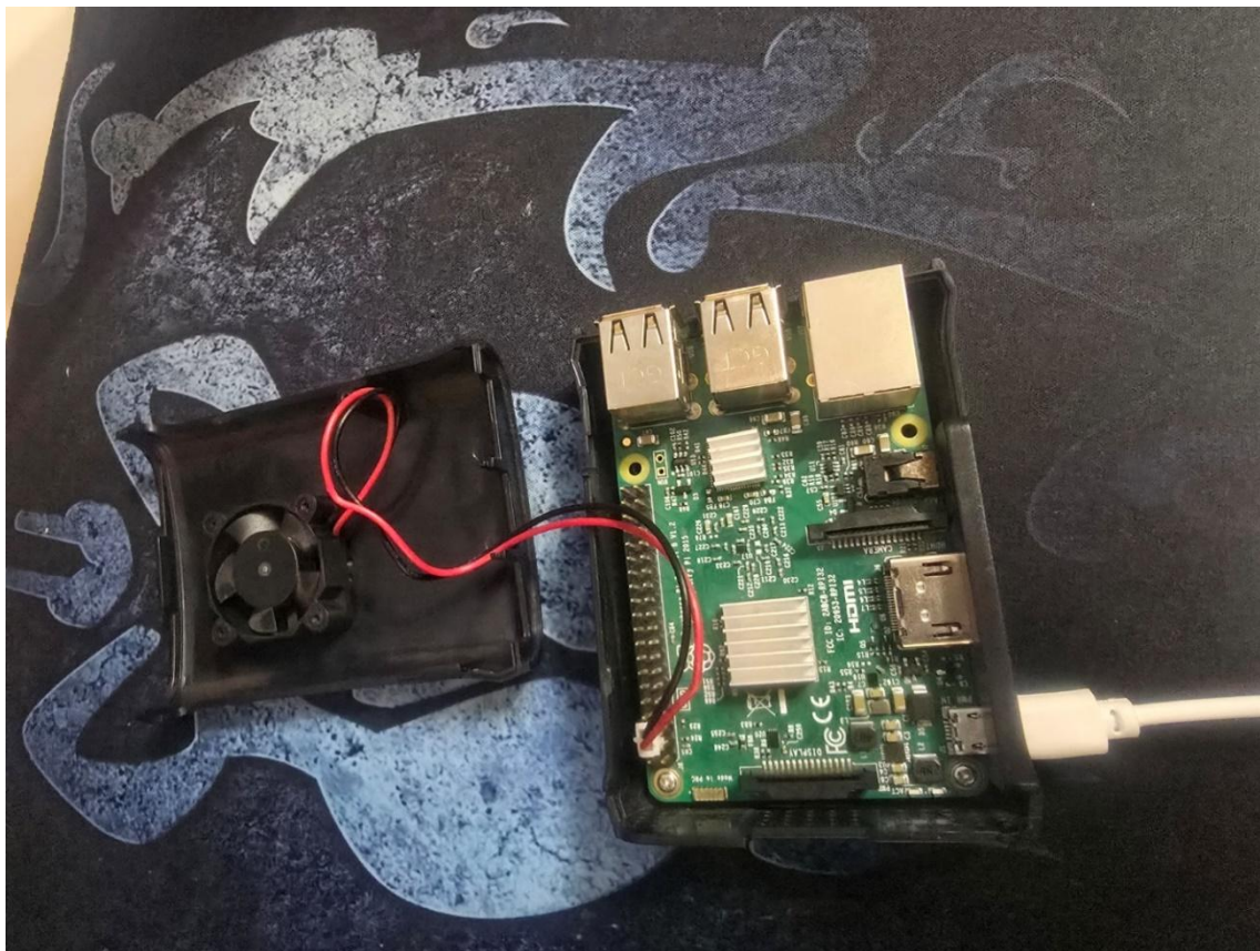
Рисунок 3.12 – Використання Raspberry Pi 3B як малоресурсного вузла в тестовому середовищі Castle Monitor
