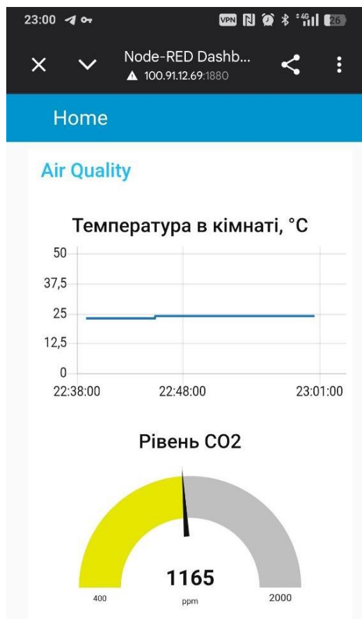
Рисунок 3.13 – Відображення панелі керування на мобільному пристрої через зашифровану мережу Tailscale (підключення через 4G/LTE)
