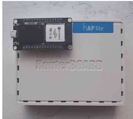
Рисунок 1.4 – Мікроконтролер ESP32 та маршрутизатор MikroTik
