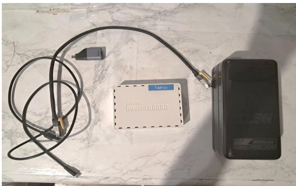
Рисунок 3.1 – Маршрутизатор MikroTik з зовнішнім акумулятором
