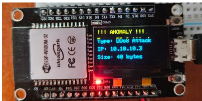
Рисунок 3.19 – Фіксація системою DDoS-атаки та виведення тривоги на екран
