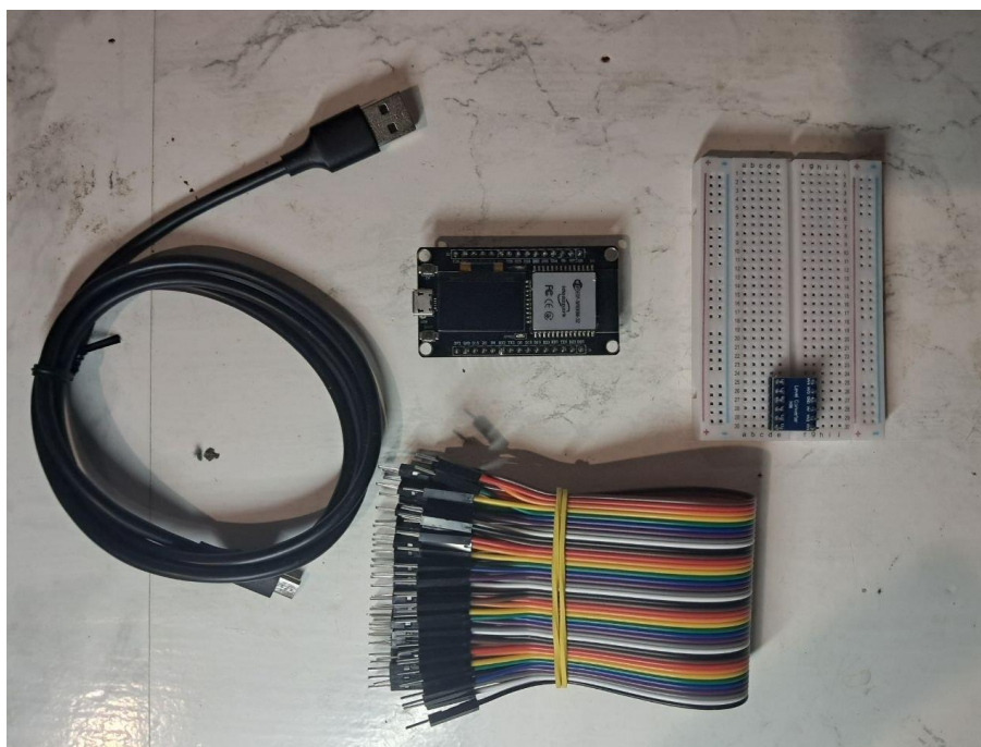
Рисунок 3.2 – Апаратний модуль сповіщень на базі мікроконтролера ESP32 та перетворювач логічних рівнів
