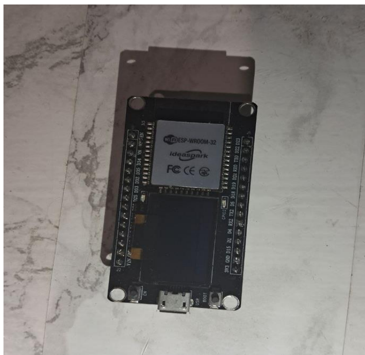
Рисунок 2.1 – Зовнішній вигляд обраної плати розробника ESP32
