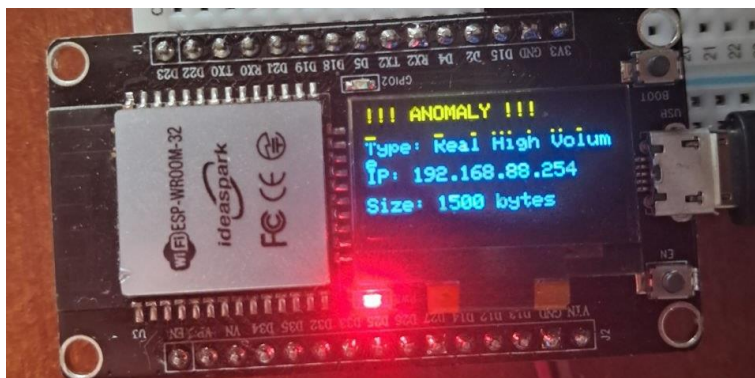
Рисунок 3.23 – Фіксація аномалії розміру пакета на мікроконтролері
