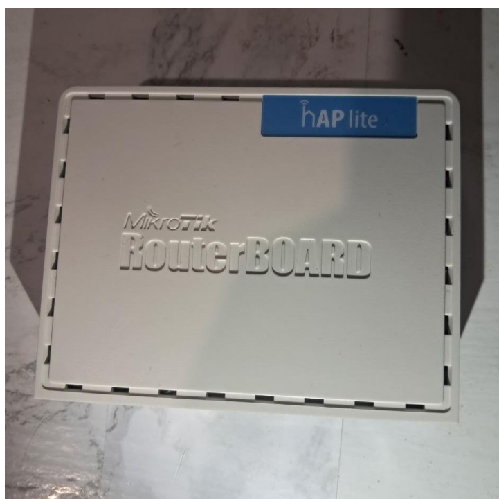
Рисунок 2.2 – Зовнішній вигляд обраного маршрутизатора MikroTik RB941-2nD
