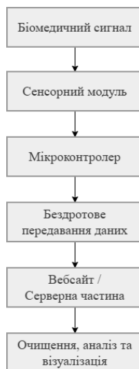
Рисунок 1.3 – Структура системи на базі IoT для збору біомедичних даних
