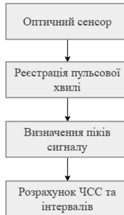
Рисунок 1.2 – Формування пульсового сигналу
