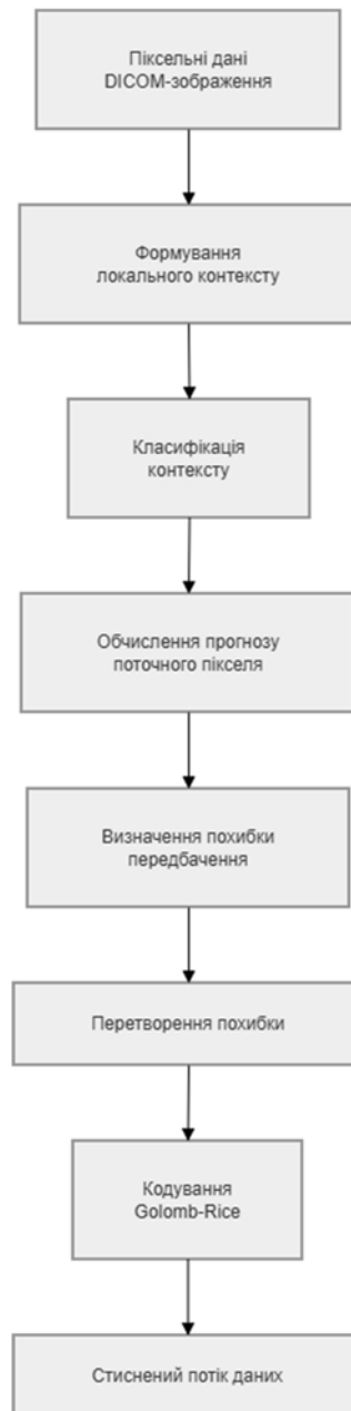
Рисунок 2.3 – Загальна схема роботи алгоритму безвтратного стискання СВРС / СВРС2
