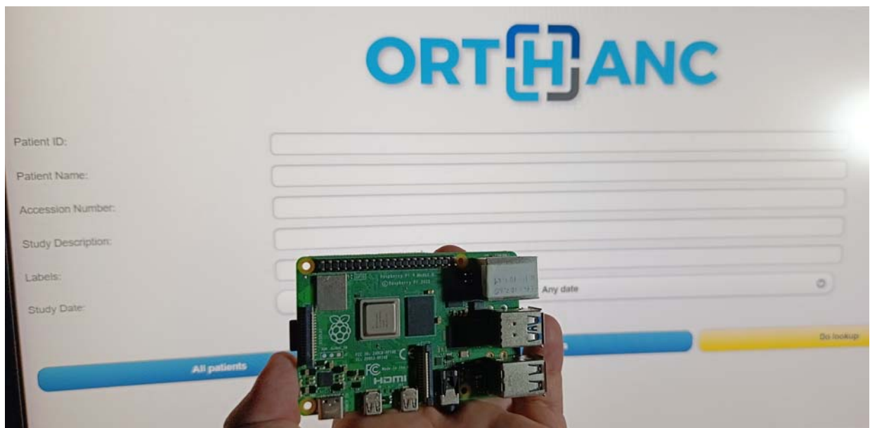
Рисунок 3.1 – Загальний вигляд експериментального стенду на основі Raspberry Pi 4 та центрального вузла з Orthanc
