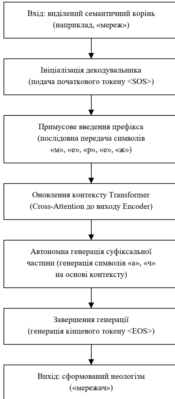
Рисунок 2.3 – Процес Forced Prefix Decoding
