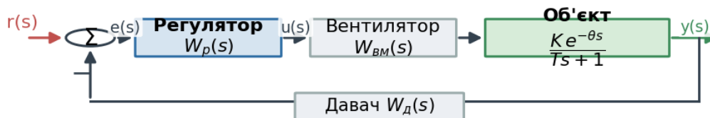
Рисунок 6.3 Структурна схема системи автоматичного керування
