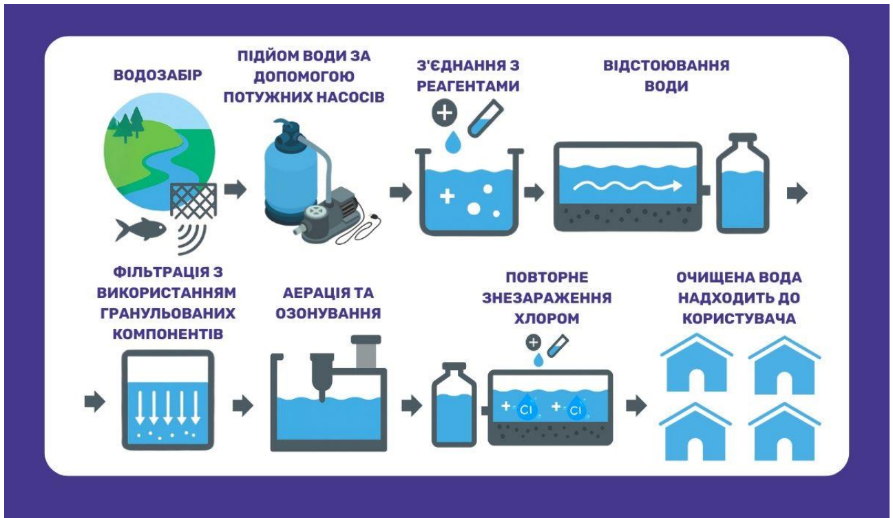
Рис.1.1. Технологічна схема очищення води на водоканалах України[22].
