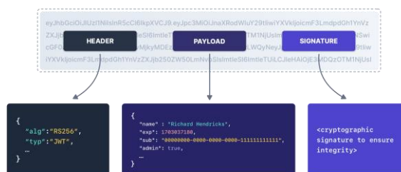
Рисунок 2.1 – Структура JSON Web Token
