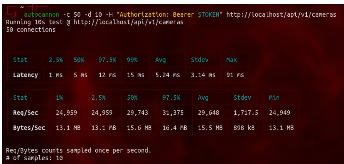
Рисунок 4.6 – Вивід autocannon із результатами навантажувального тесту
