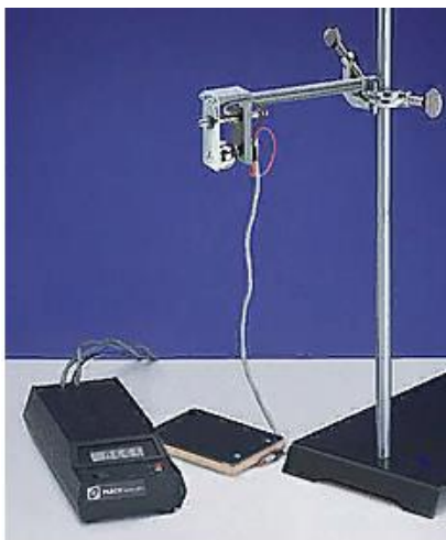
Рисунок 2. Вимірювання прискорення вільного падіння за допомогою 2 датчиків руху
