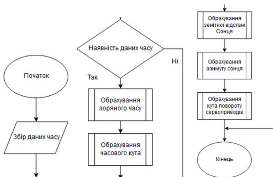
Рисунок 3 – Блок-схема роботи модулю
