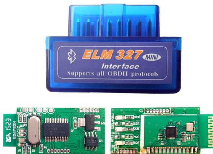
Рисунок 1 – Адаптер на мікросхемі ELM327
